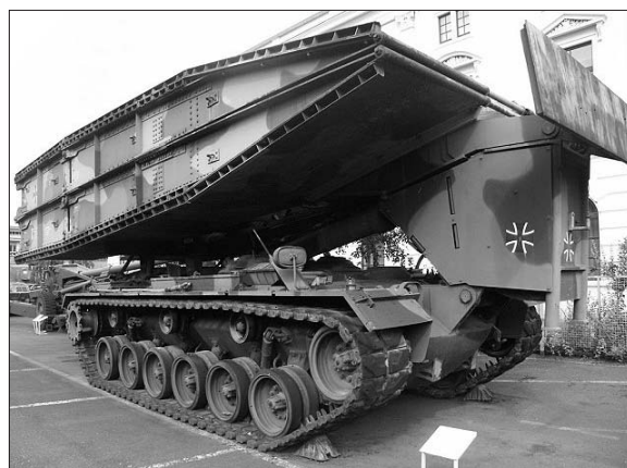
Abb. 194: Die Aufnahme zeigt die kolossalen Ausmaße des Brückenlegepanzers M48, hier ein Exemplar aus Beständen der Bundeswehr. (Foto: Jan Rehschuh, WIKIPEDIA, CC BY-SA 3.0)
